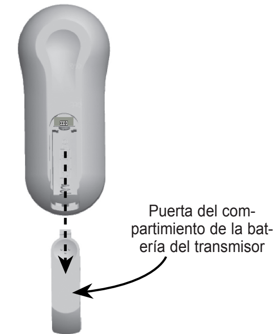
Figura 3 - Retiro de la puerta del Compartimiento de la batería del transmisor
